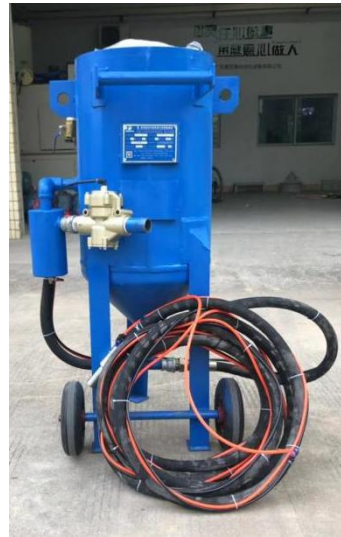
移动开放式喷砂罐设备配置示意图
